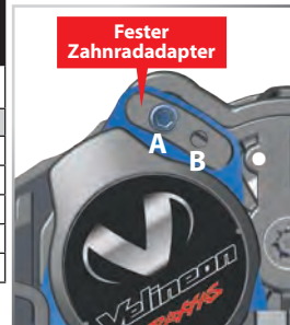
Motorschraubenposition im Zahnradadapter für die Einstellung des Zahnabstands
