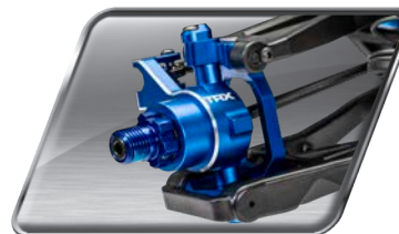
C-Radnaben und Lenkungsblöcke aus Aluminium
