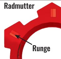
Positionieren Sie die Rungen auf der Radmutter in Richtung des Rads, wenn Sie sie auf der Achse montieren.
